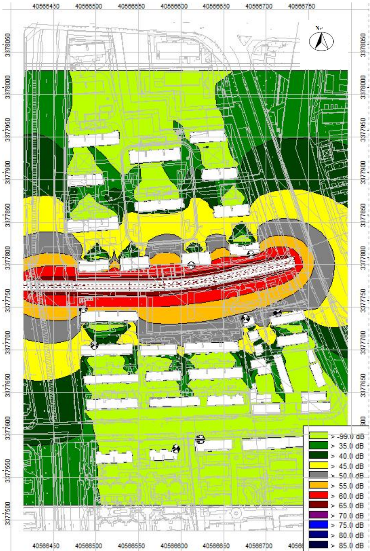
图9 农丰十六组南侧道路（九虎路至农丰路）典型路段昼间等声级线图（中期）
