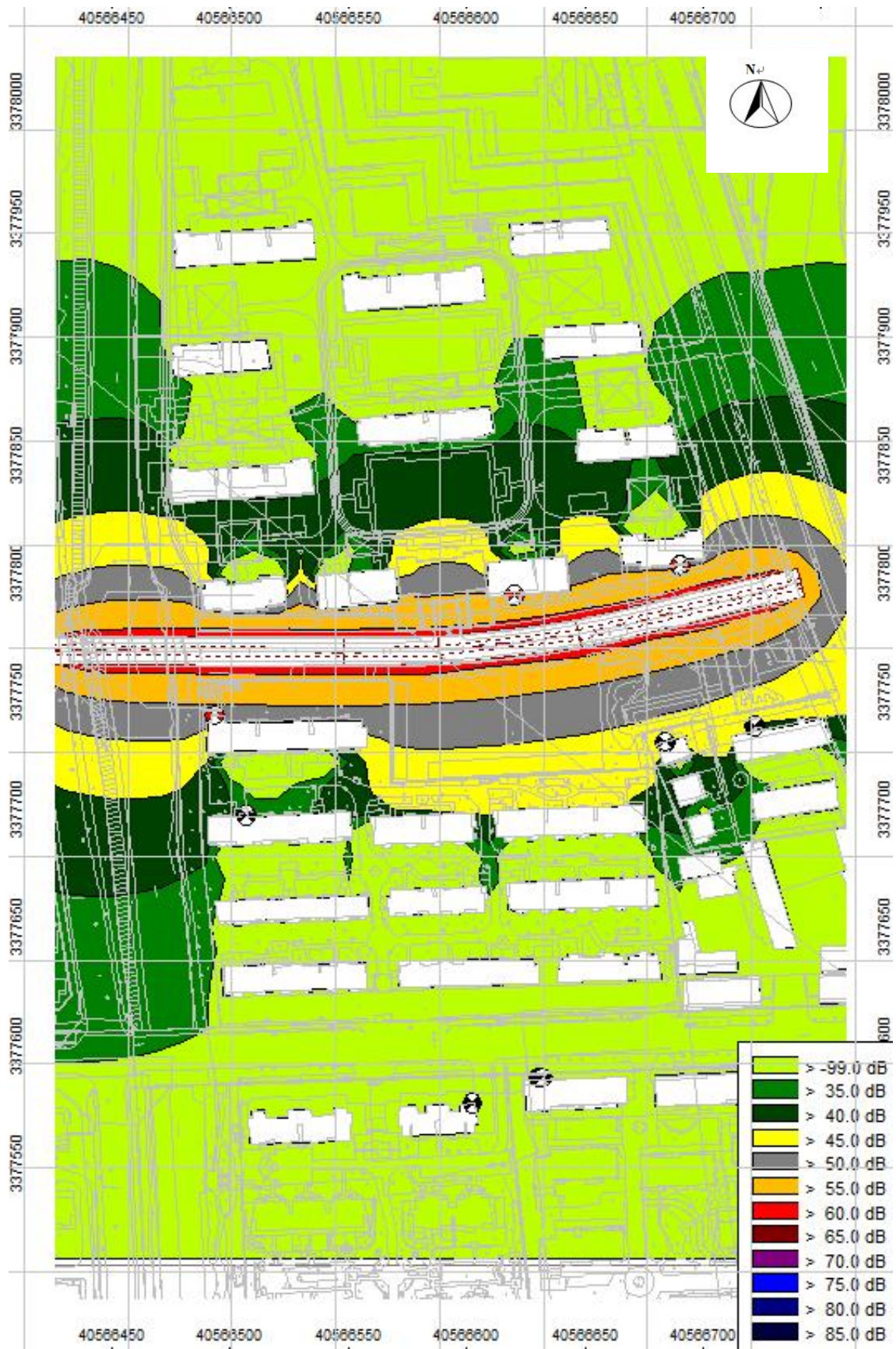
图 12 农丰十六组南侧道路（九虎路至农丰路）典型路段夜间等声级线图（远期）
