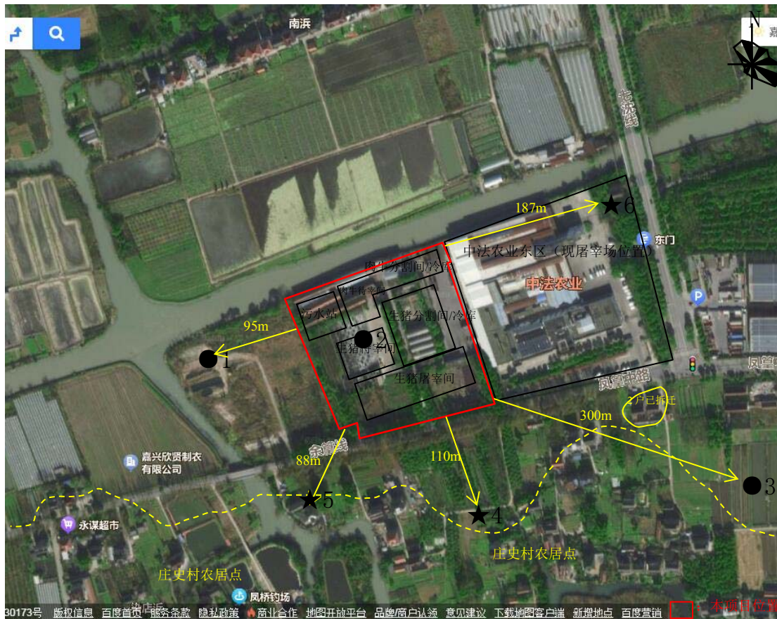
●地下水监测点位、★地下水监测点位，其中 1—3 号均监测地下水及水位，4—6 号仅监测地下水。
