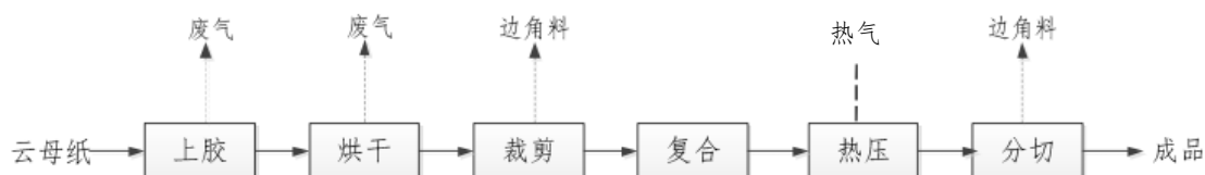
图 1-1 云母板生产工艺流程及产物环节图
