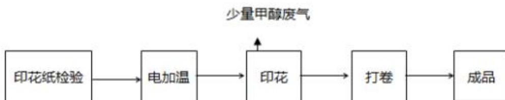
图 1-2 转移印花生产工艺及产排污环节图
