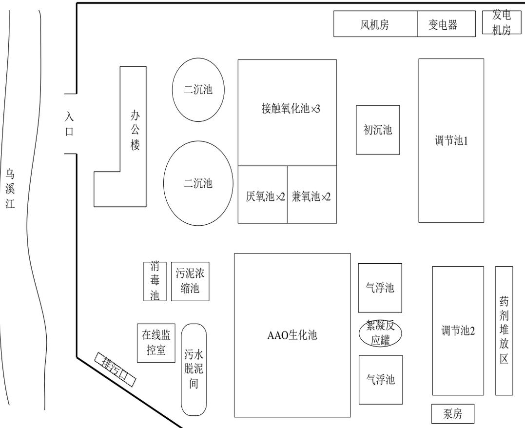
图 2-1 沈家污水处理厂生产设施分布图
