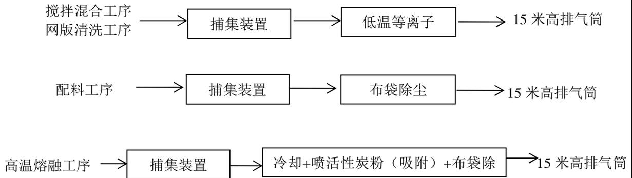
图 7-1 废气处理工艺流程图
